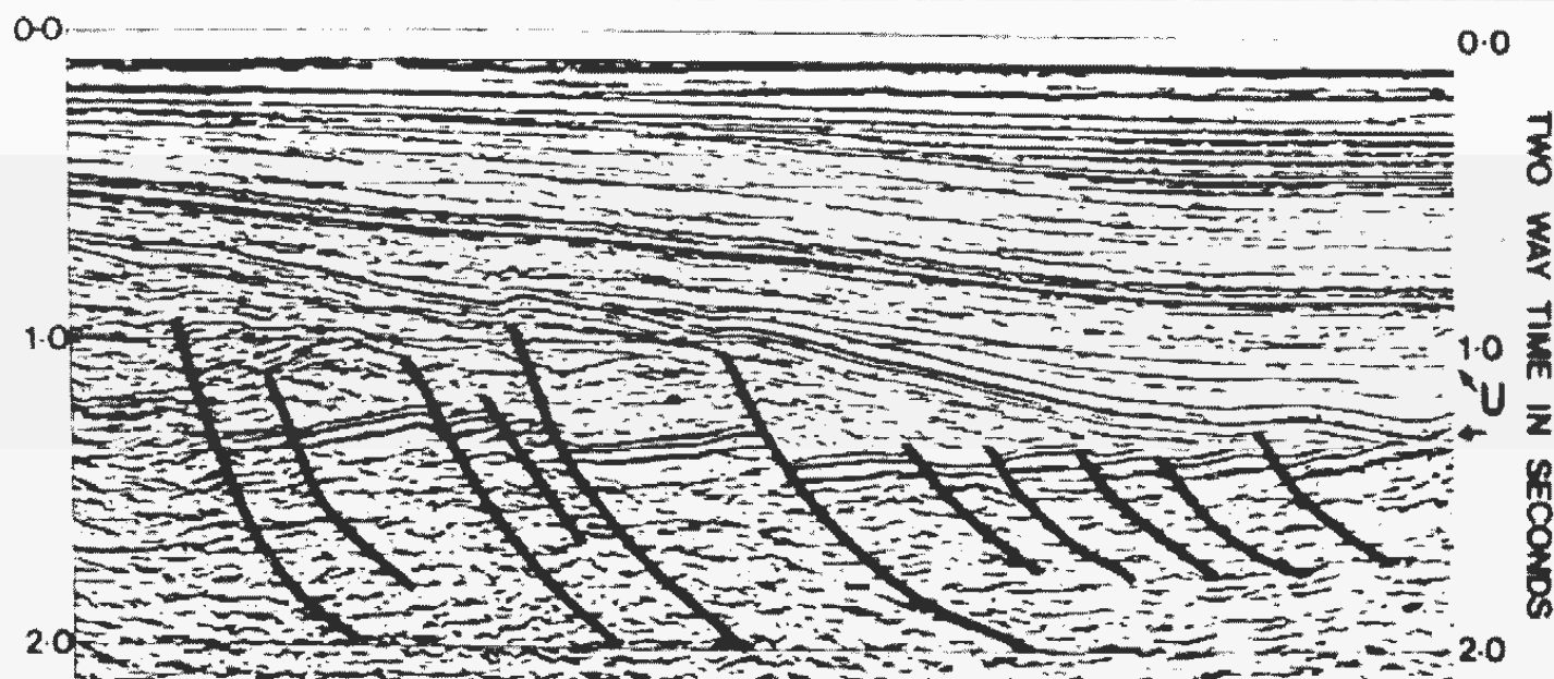
شکل ۸-۵۶ - پدیده onlapping (بین دو فلش) بر روی یک سطح ناپیوستگی
