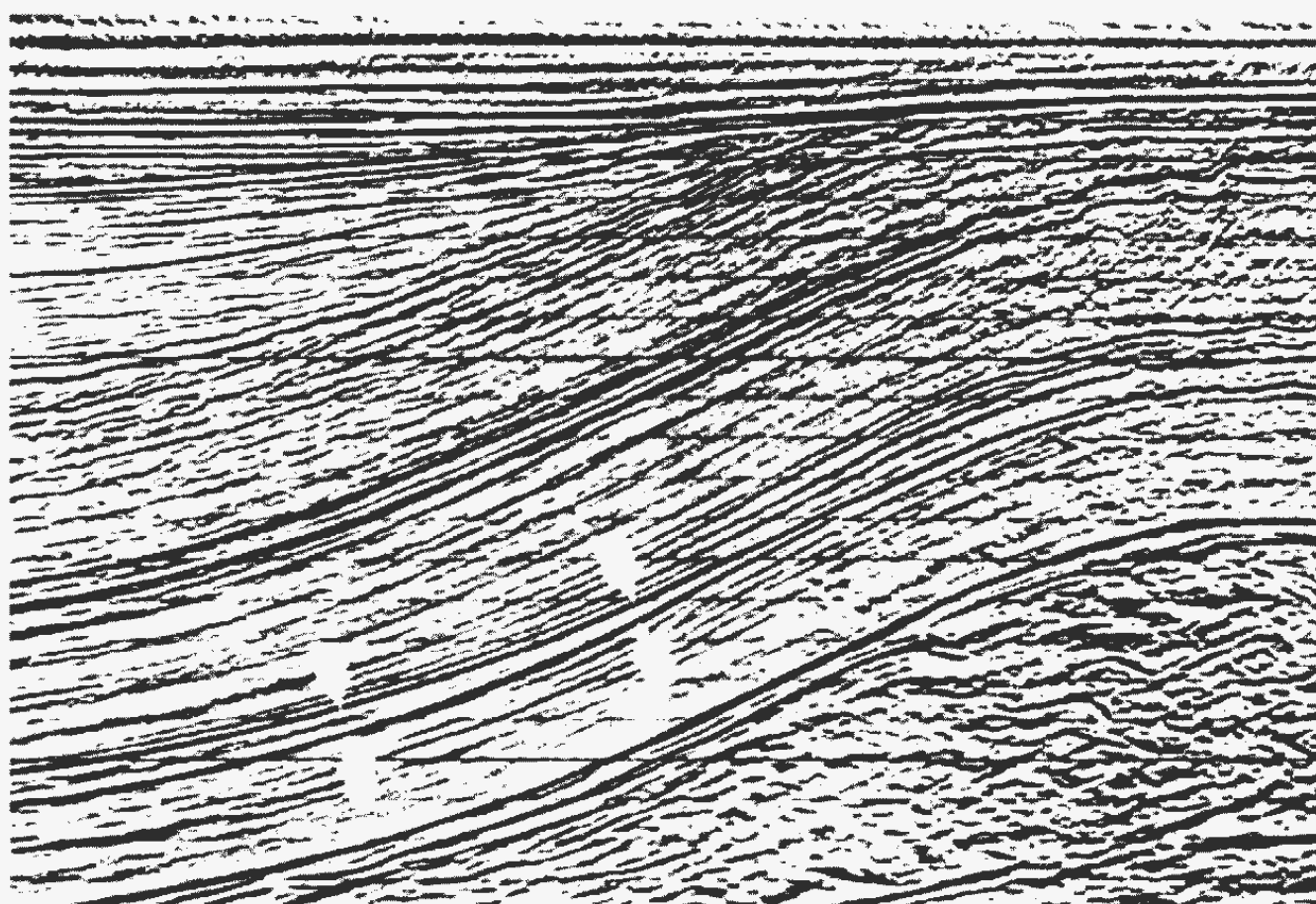
شکل ۸-۶۳ - همگرایی دو سطح ناپیوستگی (فلش سفید) در مقطع لرزه‌ای
