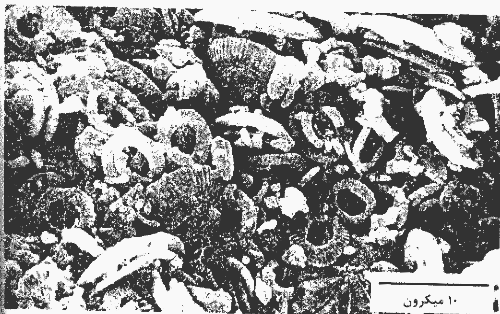
شکل ۷-۷۴ - تخلخل اولیه بین دانه‌ای و میان دانه‌ای در کوکولیت‌ها
