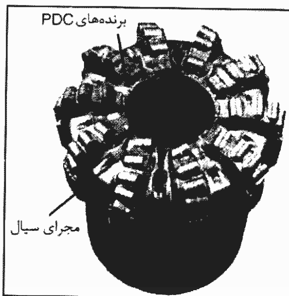
شکل ۱۱-۱۰ - نمونه‌ای از مته‌های مغزه گیر
